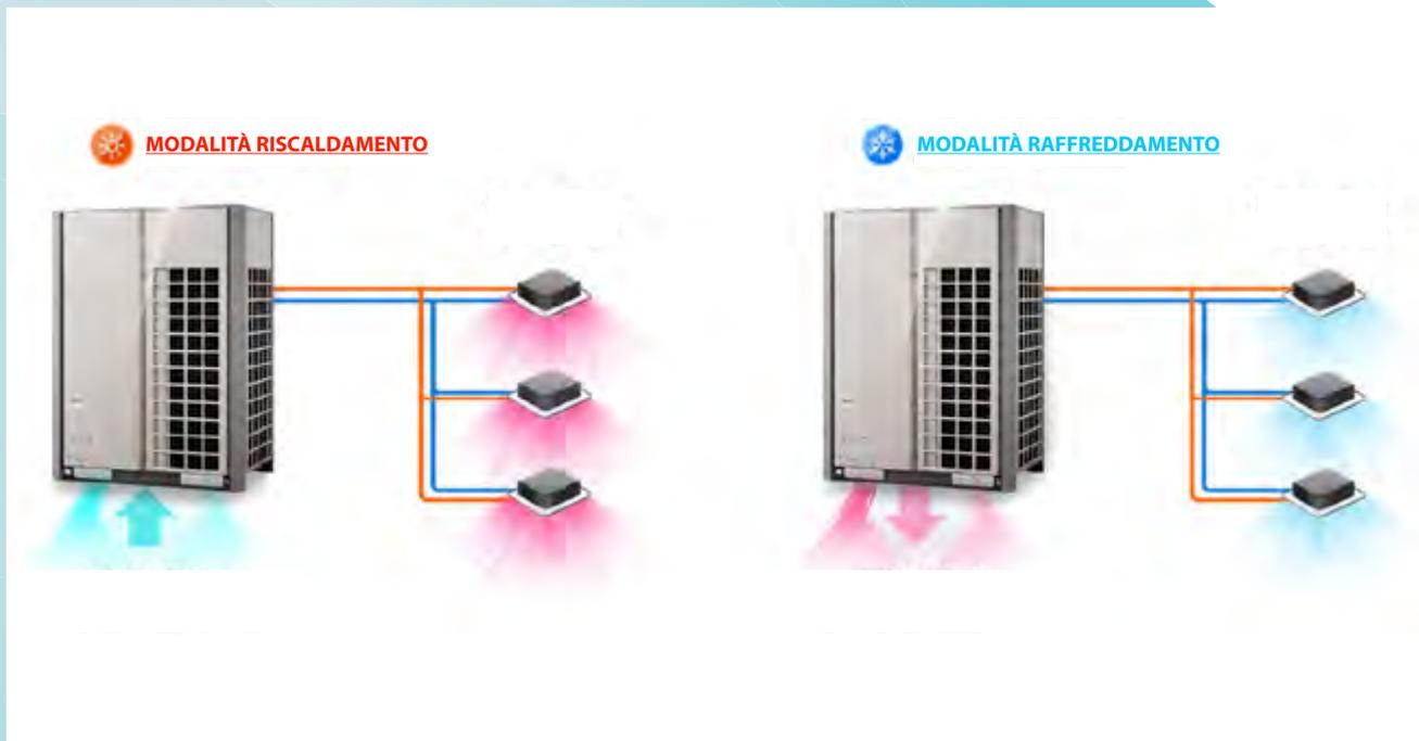
Come si evince dalla figura sottostante, il posizionamento degli elementi di ventilazione all'interno della zona di benessere, contribuisce a tagliare l'effetto di stratificazione, effetto che viene a crearsi negli impianti tradizionali dovuta all'elevata temperatura del fluido termovettore e dalla posizione alta degli apparecchi
